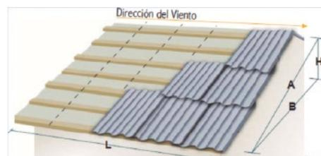
Sentido de instalación de cubierta en relación al viento. Fig. 1
